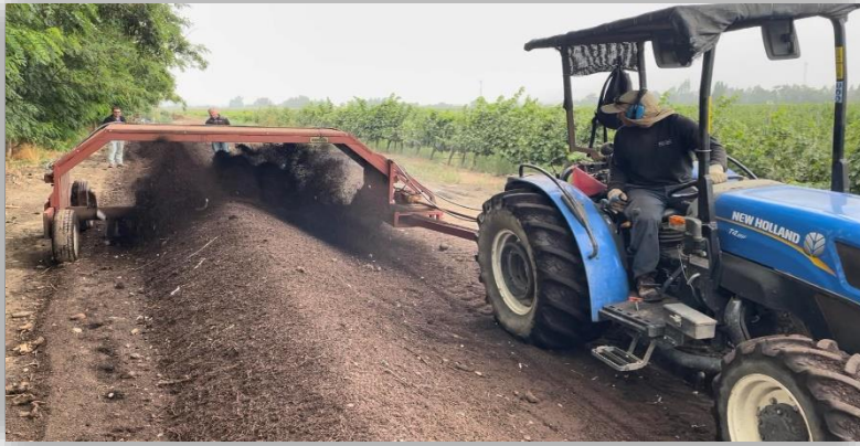
Volteadora de compost para airear y bajar temperatura, diseñada y construida en fundo El Peral, con reutilización de materiales. Por don Arturo San Martín.
